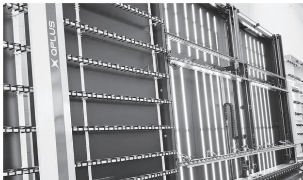
従来の欠点検査装置では難しかった、指紋、水滴の乾燥跡、薄いひっかき傷などを検知
