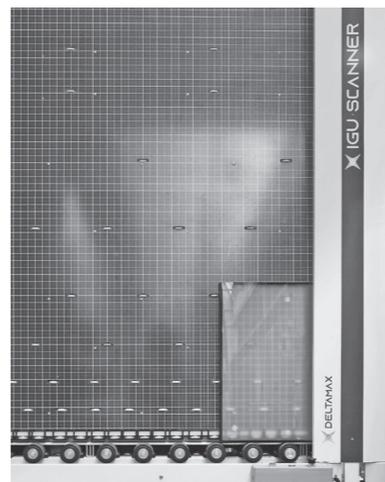
複層ガラス自体の自動検査が可能で、最大80mm厚のトリプルガラスにも対応
