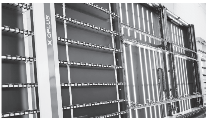
複層ライン用縦型ガラス検査装置「ガラスインスペクター・キュープラス」
