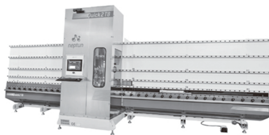
ネプチューン社の縦型穴開け機「クイックドリル」(上)とミリーング機能を加えた「クイックツー」
