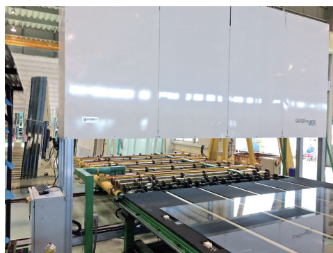
デルタマックス社の切断前欠点マーク検出装置「グラスインスペクター・オーピーティー」
