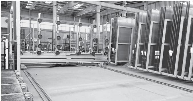
自動素板供給システム「テレスコピックローダー」への素板供給を自動化したい」「異なる素板品種を切断ラインへ投入することが多い」といったニーズに適する。イタリア・オプティマ社のガラス切断最適化システムと連動できる。
